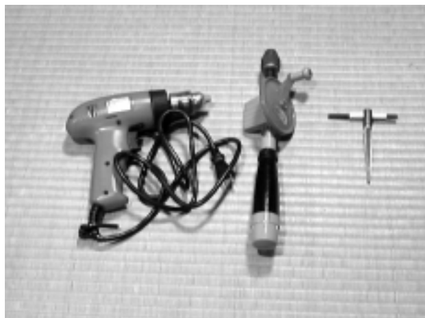
写真7 ドリルドライバー、ハンドドリル、ハンドリーマー
